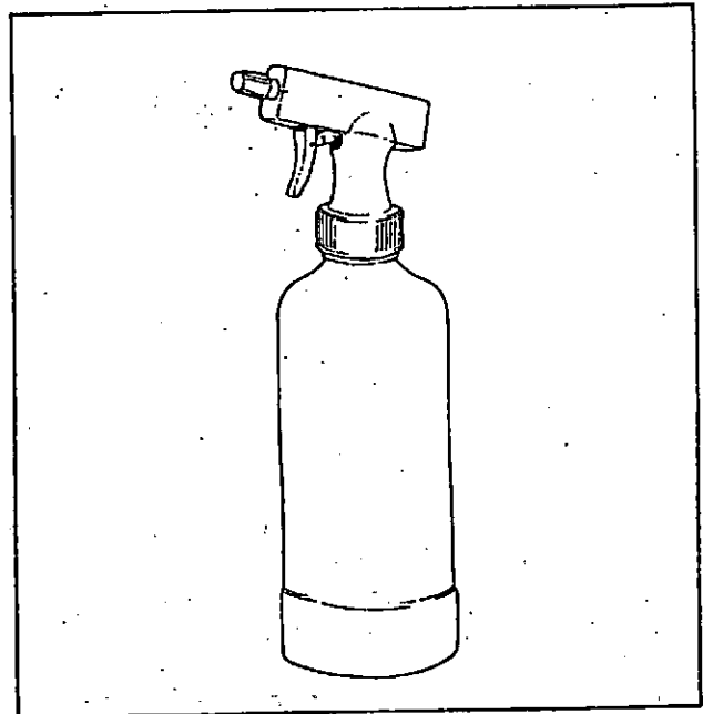
Figura 11.—Un típico pulverizador que puede encontrarse en cualquier tienda especializada: consiste en una botella donde va el líquido que se quiere pulverizar (en nuestro caso, agua), un pulverizador de pistola y una boquilla cuya apertura se puede regular.
